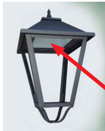
Primer stilske svetilke, kjer je sijalka nameščena v zgornjem delu. Svetilka je brez stranskih stekel, saj ta sipljejo svetlobo nad vodoravnico.
