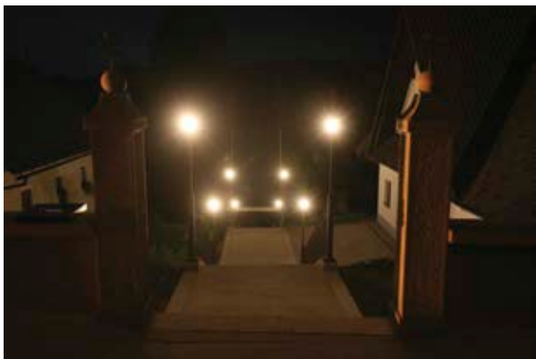
Vhod v cerkev, opremljen z nezasenčenimi svetilkami na nizkih drogovih, ki svetijo v oči iz neposredne bližine.
